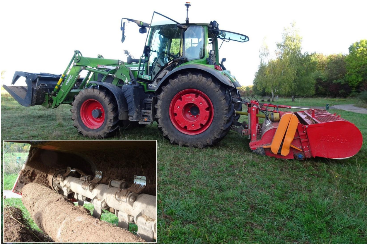
Abb. 4: Die Anlage der speziellen Mulchstreifen erfolgte mit einem schweren Mulchgerät der Firma Dücker (Modell UM 23). Gewählt wurde die Ausführung mit schweren Schleißeln und integriertem Fangkorb und einer Arbeitsbreite von 2,30 m (Fotos: S. Sändig).
