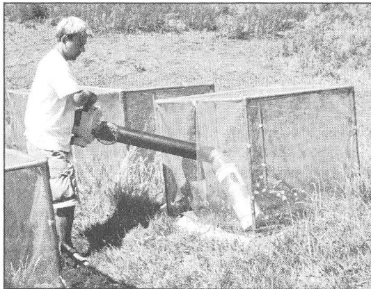
Abb. 1: Die zur Ermittlung der Schlupfraten verwendeten Schlupfkäfige. Hier ist das Absaugen der im Käfig befindlichen Larven mittels eines umgebauten Laubsaugers gezeigt.
